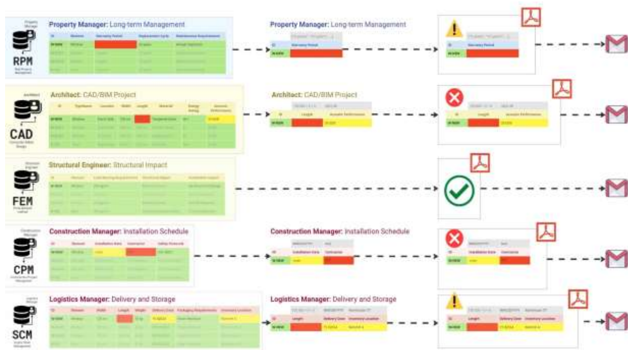
Abb. 4.4-18 Automatische Inspektionsberichte erleichtern das Verständnis von Fehlern und beschleunigen die Arbeit bei der Vervollständigung der Projektdaten.
