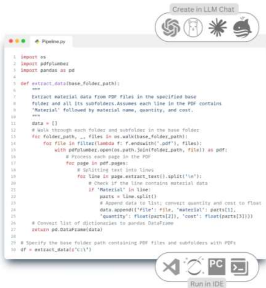
Рис. 7.2-18 LLM создаёт Python-код для извлечения данных из PDF-файлов в определенной папке и всех ее подпапках.
