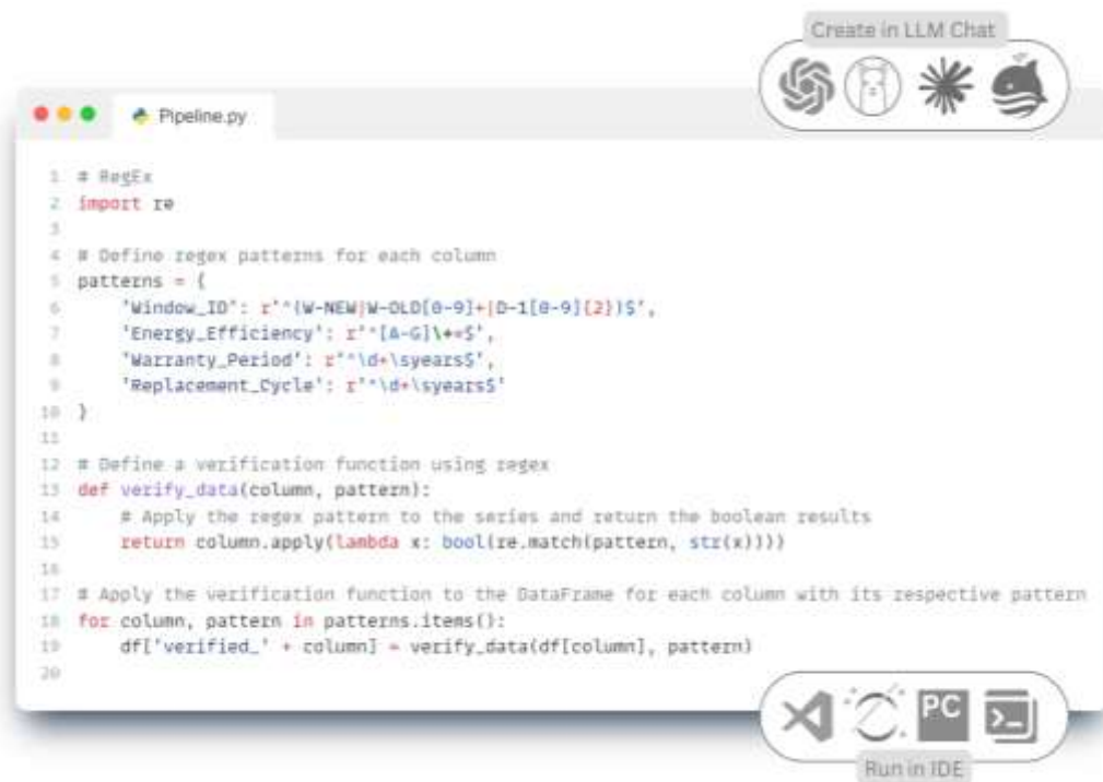
Рис. 7.2-8 Код автоматизация процесса проверки путем применения шаблонов RegEx к колонкам параметров датафрейма.
