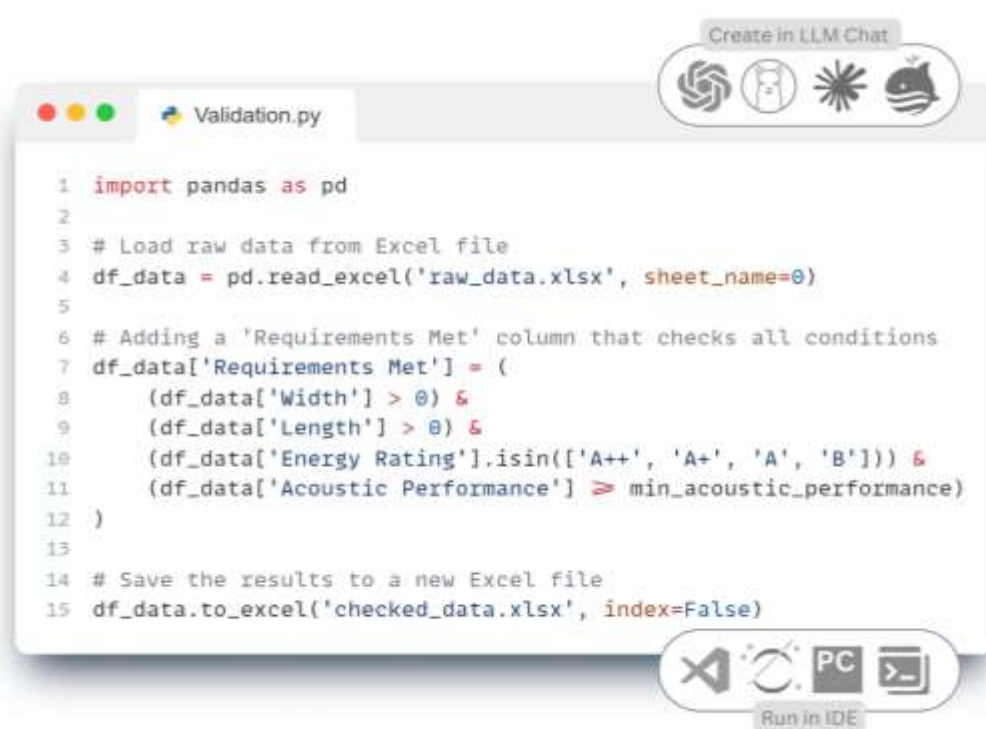
Рис. 4.4-14 Код, сгенерированный LLM-моделью проверяет преобразованный CAD (BIM) проект на соответствие требованиям к атрибутам в виде граничных значений.
