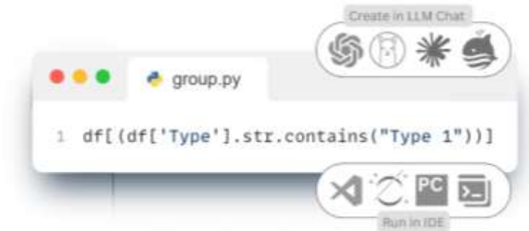
Рис. 5.2-6 Одна строка кода, написанная с помощью LLM, позволяет сгруппировать весь CAD проект по атрибуту "Тип" и получить нужную группу элементов.
