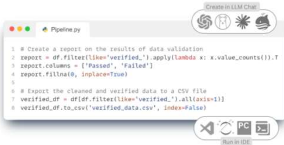
Рис. 7.2-17 Проверенные данные, полученные на этапе Transform из итогового датафрейма экспортируются в CSV-файл для интеграции с другими системами.
