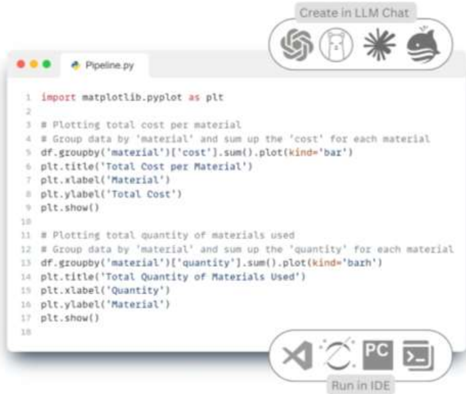
Рис. 7.2-20 Ответ LLM-модели в виде кода Python для визуализации данных из фрейма данных с помощью библиотеки matplotlib.
