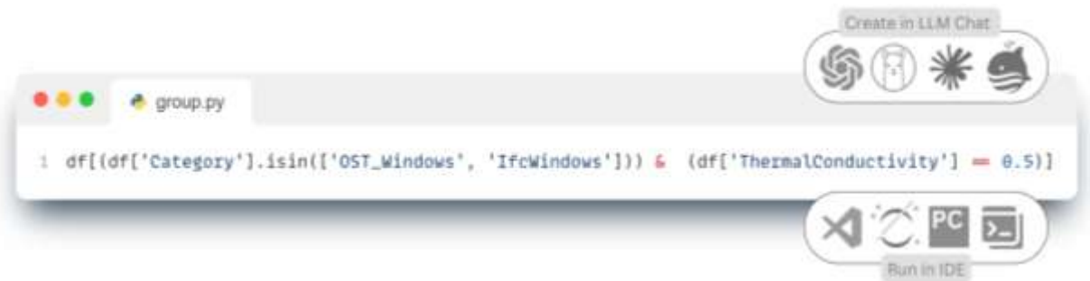
Рис. 5.2-11 Крайне простой язык запросов Pandas Python позволяет проводить QTO для любого количества проектов одновременно.
