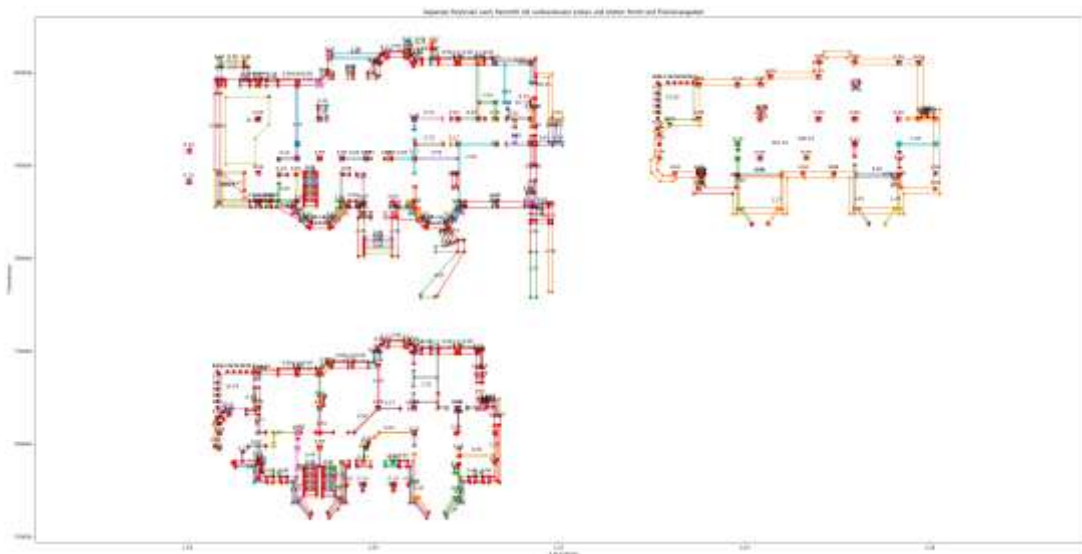
Рис. 6.4-9 LLM дополнил код, который берёт значения площади для каждой полилинии и добавляет его на изображение с визуализацией линий.
