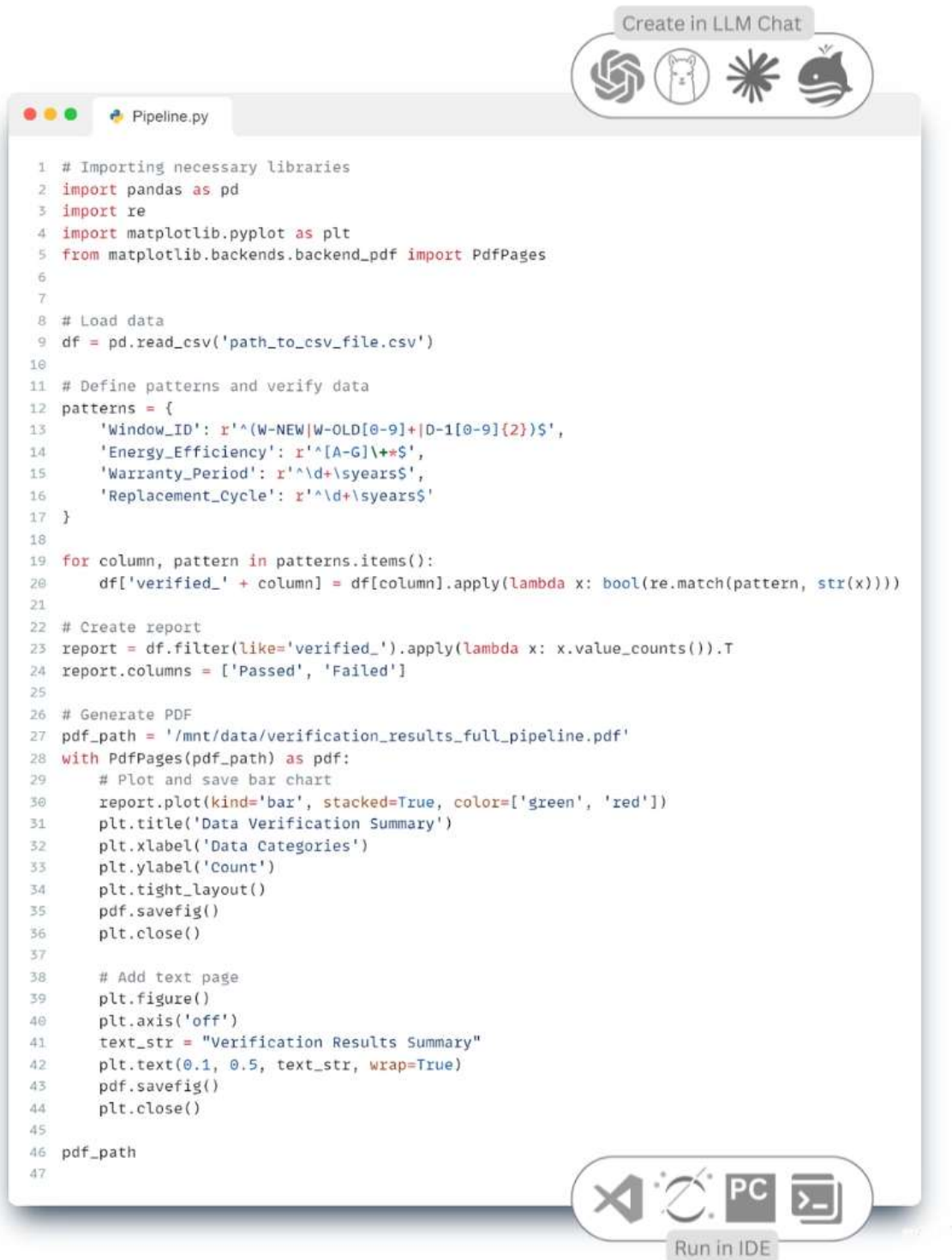
Рис. 7.3-6 Pipeline (ETL) автоматизирует полный цикл обработки данных: от загрузки и проверки до создания структурированного отчета в формате PDF.
