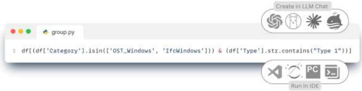
রিস. 5.210 একটি কোডের লাইন, যা এক্সেল সূত্রের মতো, সমস্ত প্রকল্পের উপাদানগুলিকে একাধিক বৈশিষ্ট্যের ভিত্তিতে গ্রুপ করতে সক্ষম।
