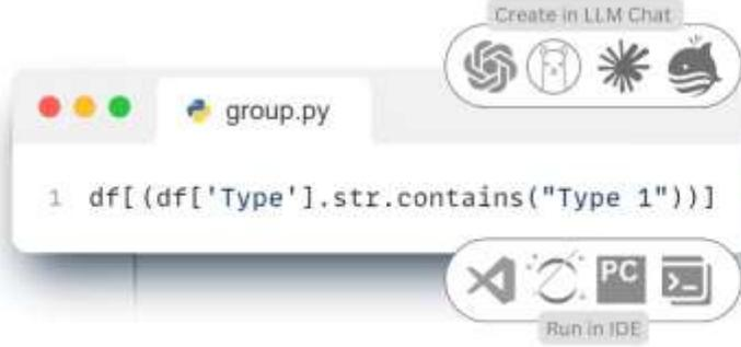
চিত্র ৫.২৬ একটি লাইনের কোড, যা LLM দ্বারা লেখা হয়েছে, পুরো CAD প্রকল্পকে "Type" অ্যাট্রিবিউটের ভিত্তিতে গ্রুপ করতে এবং প্রয়োজনীয় উপাদানগুলির একটি গ্রুপ পেতে সক্ষম করে।
