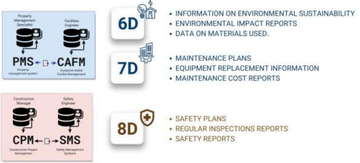
চিত্র 5.34 6D, 7D এবং 8D এর অ্যাট্রিবিউটগুলি তথ্য মডেল ডেটাতে প্রকল্পের বিভিন্ন দিকগুলি, শক্তি দক্ষতা থেকে নিরাপত্তা পর্যন্ত, বিস্তৃত করে।
