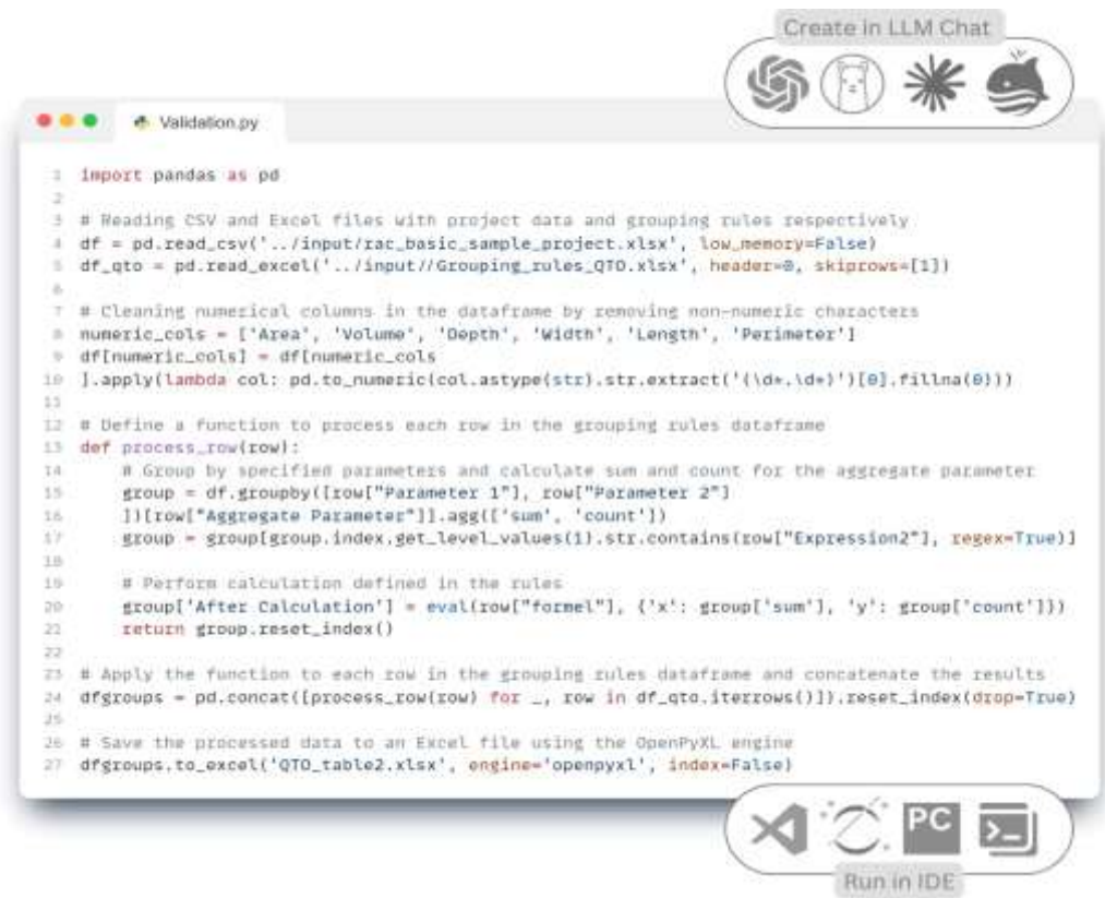
图 5.2-13 Python 代码 Pandas 处理 CAD 项目中的设计数据，并根据 Excel 中定义的规则进行分组。
