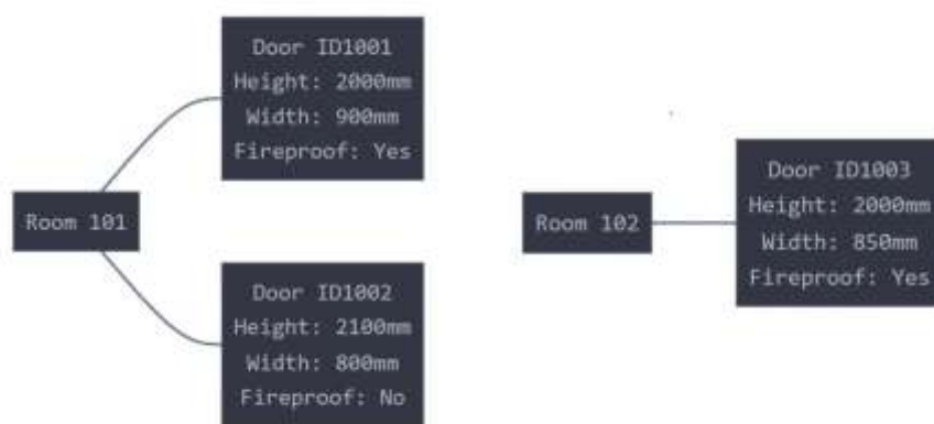
图 3.2-9 图表示视图中的项目门实体信息。
