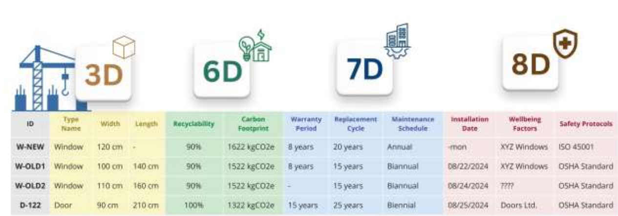
图 5.3-5 6D -8D 将属性层添加到数据信息模型中，该模型已包含来自三维 - 模型的几何和体积属性。
