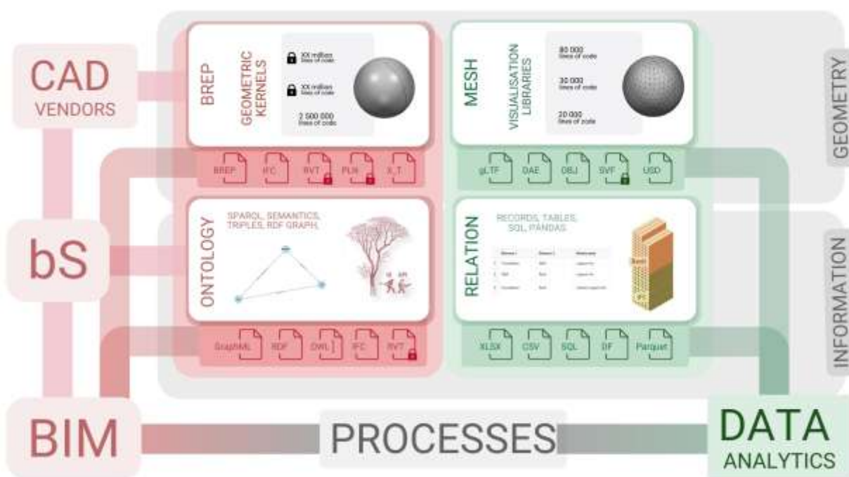
图 6.1-10 施工过程中的几何与信息：从复杂的 CAD 和 BIM- 系统到用于分析的简化数据。
