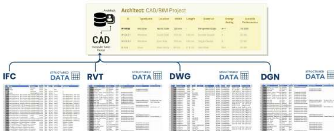
图 4.4-11 来自 CAD 系统的结构化数据 可以是一个二维表格, 列表示元素的属性。
