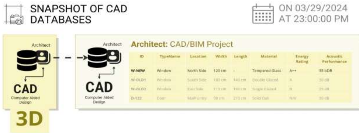
图 4.4-10 CAD 数据库快照 (BIM) 显示当前版本项目模型中 "窗口" 类新实体的当前属性信息。
