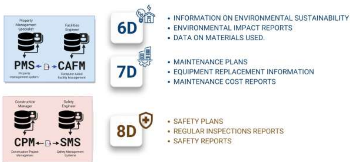
图 5.3-4 数据信息模型中的属性 6D、7D 和 8D 扩展了对项目各个方面的考虑，从能源效率到安全
